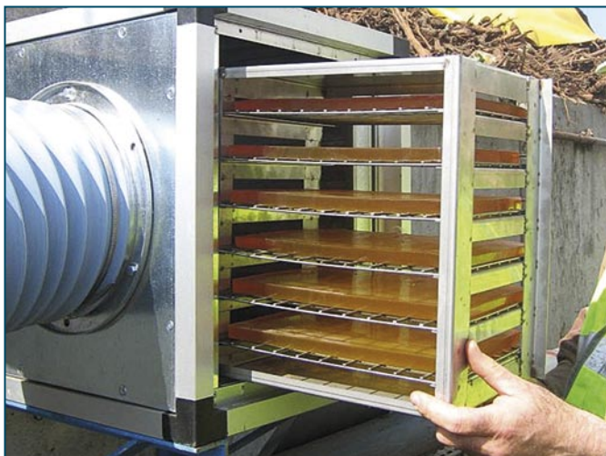
Rys. 5. Wspomaganie pracy biofiltra w oczyszczalni ścieków. Skrzynka z płytkami żelowymi IDRAGEL SUB
